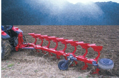
Charrue vérisibles portée pour labour superficiel pour un travail du sol minimal
