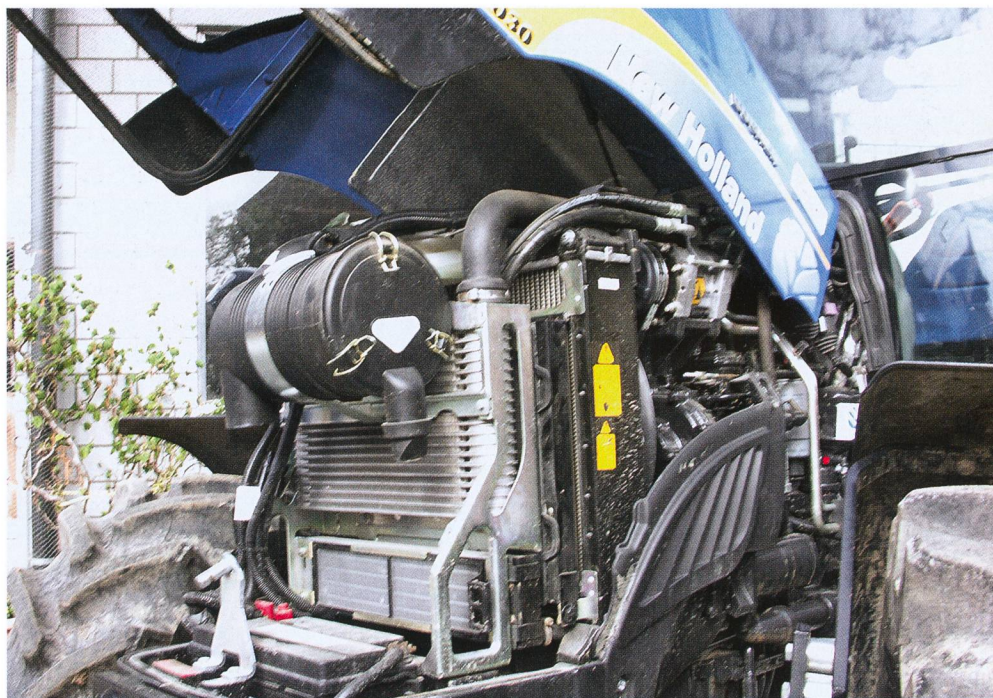
Le nouvel IVECO F5C quatre cylindres, moteur turbo avec refroidissement d'air de suralimentation et recyclage des gaz d'échappement. Le test confirme les performances élevées, la faible consommation de carburant et l'observation des prescriptions antipollution. (Photos: Ueli Zweifel)
