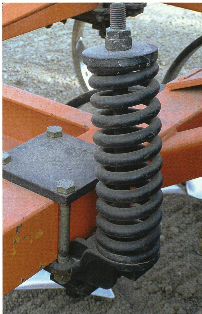
Sécurité contre les surcharges avec ressort en spirale.
