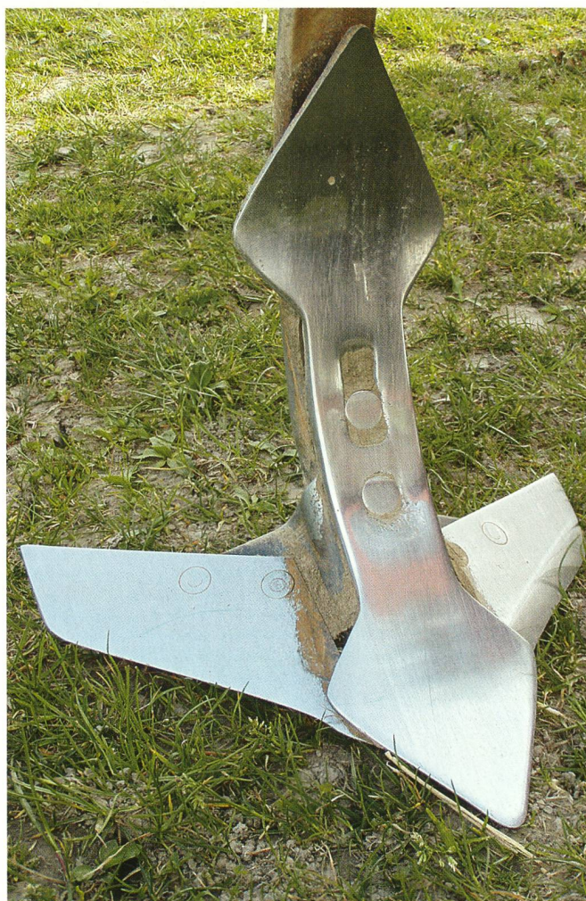
Pour le travail superficiel, le soc à ailettes est très approprié.
