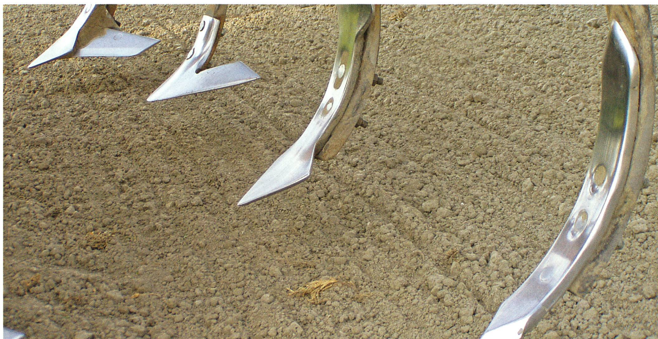
De gauche à droite: Socs à ailettes, en patte d'oie, bombé ou en pointe, tels sont les outils habituels de travail équipant les déchaumeuses. (Photos: Ruedi Hunger)
