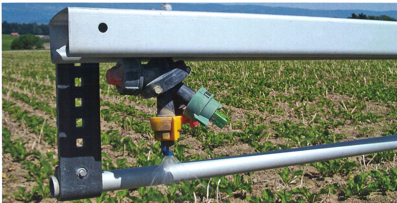
Le large éventail d'utilisation d'un pulvérisateur peut difficilement être couvert par un seul type de buse. Dans la pratique, des corps de buses multiples ont fait leurs preuves. (Photos: Bernhard Streit)
