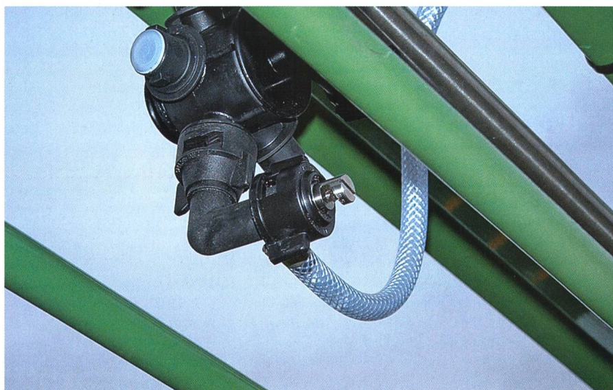
Buse deux composants John Deere (Twin Fluid). La bouillie de traitement est mélangée avant sa sortie à de l'air sous pression dans une pré-chambre. (Photo d'usine)
