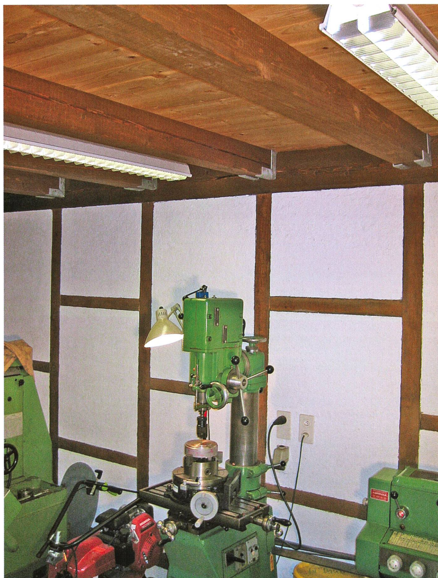
Eclairage de base avec lampes FL équipées de réflecteurs blancs (concentration lumineuse vers le bas et protection anti-éblouissement). Une lampe annexe, avec allumage indépendant, veille à un bon éclairage de la perforatrice.
