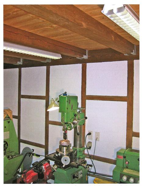
Eclairage de base avec lampes FL équipées de réflecteurs blancs (concentration lumineuse vers le bas et protection anti-éblouissement). Une lampe annexe, avec allumage indépendant, veille à un bon éclairage de la perforatrice.
