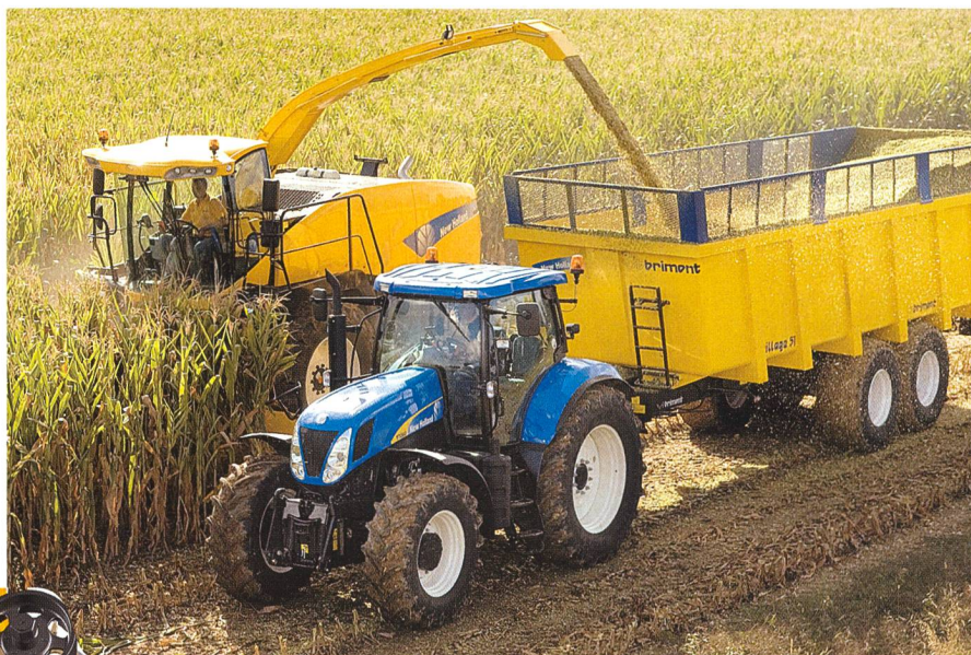
Dans la série FR9000 de New Holland, le nouveau système Variflow est utilisé. Celui-ci permet le recul de 60 cm de la soufflerie lorsque les rouleaux éclateurs sont occultés, ce qui la rapproche du tambour hacheur.
