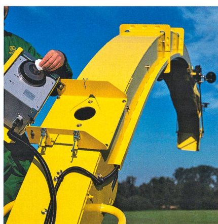
Les machines i de John Deere disposent d'un capteur infrarouge qui détermine le taux d'humidité du fourrage. Ainsi, la longueur de coupe peut être adaptée automatiquement en continu.
