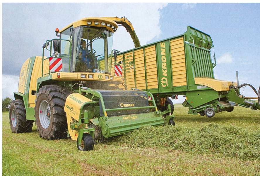
Krone équipe ses modèles Big X de six rouleaux ameneurs. Le pick-up EasyFlow travaille sans dispositif de pilotage.
