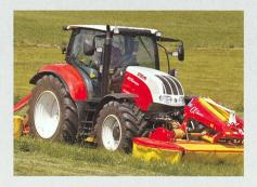
24×24 offre 3 groupes de 4 vitesses avec deux demi-vitesses passables sous charge. L'inverseur Powershuttle pour un changement de direction confortable est
