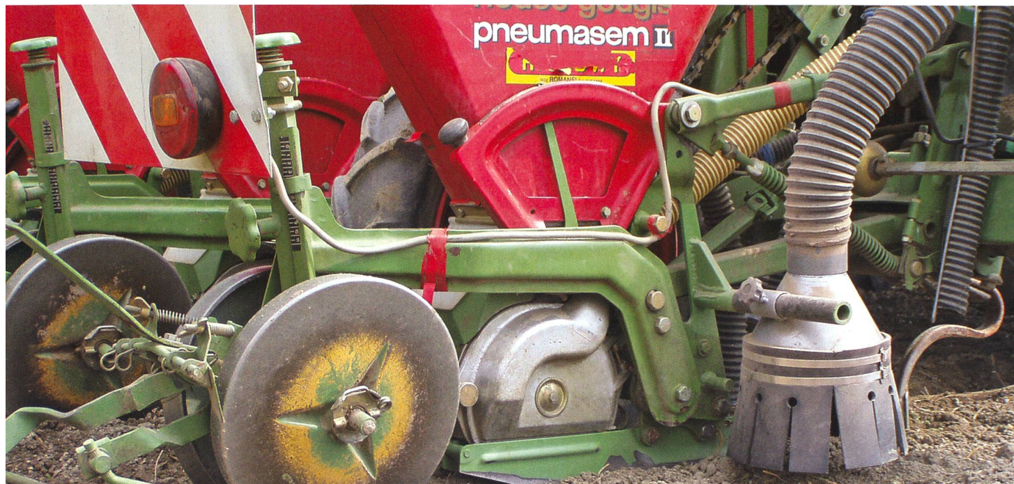
Lors d'ensemencement à l'aide d'un semoir pneumatique, celui-ci doit être équipé d'un déflecteur qui libère le flux d'air expulsé en direction et à proximité du sol. (Photo: Ruedi Hunger)
