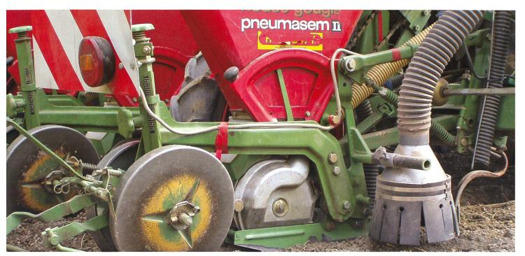
Lors d'ensemencement à l'aide d'un semoir pneumatique, celui-ci doit être équipé d'un déflecteur qui libère le flux d'air expulsé en direction et à proximité du sol. (Photo: Ruedi Hunger)
