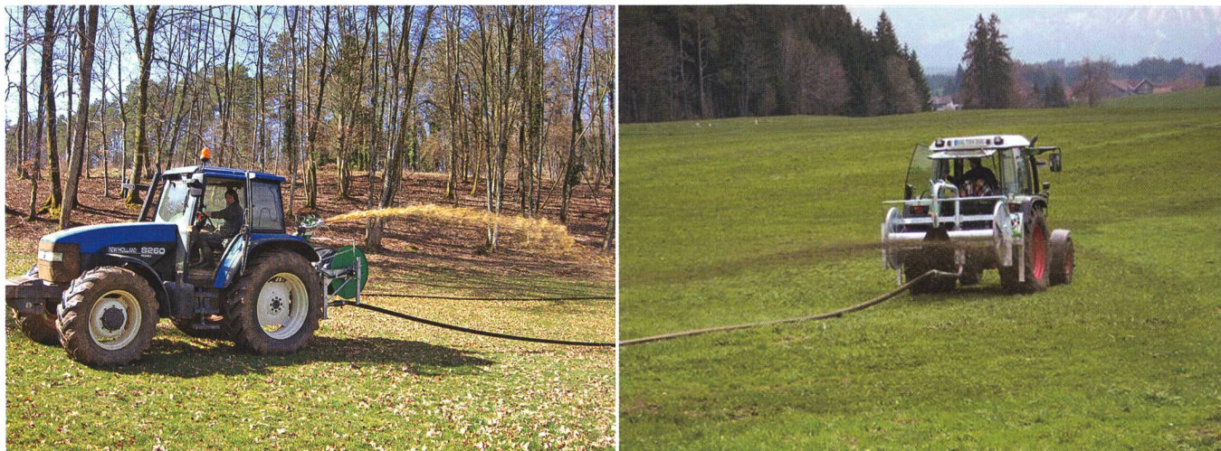
La répartition automatique du lisier avec buse de projection (Fankhauser SA) ou déflecteur (Hochdorfer Technik SA) assure une quantité d'épandage relativement constante.
