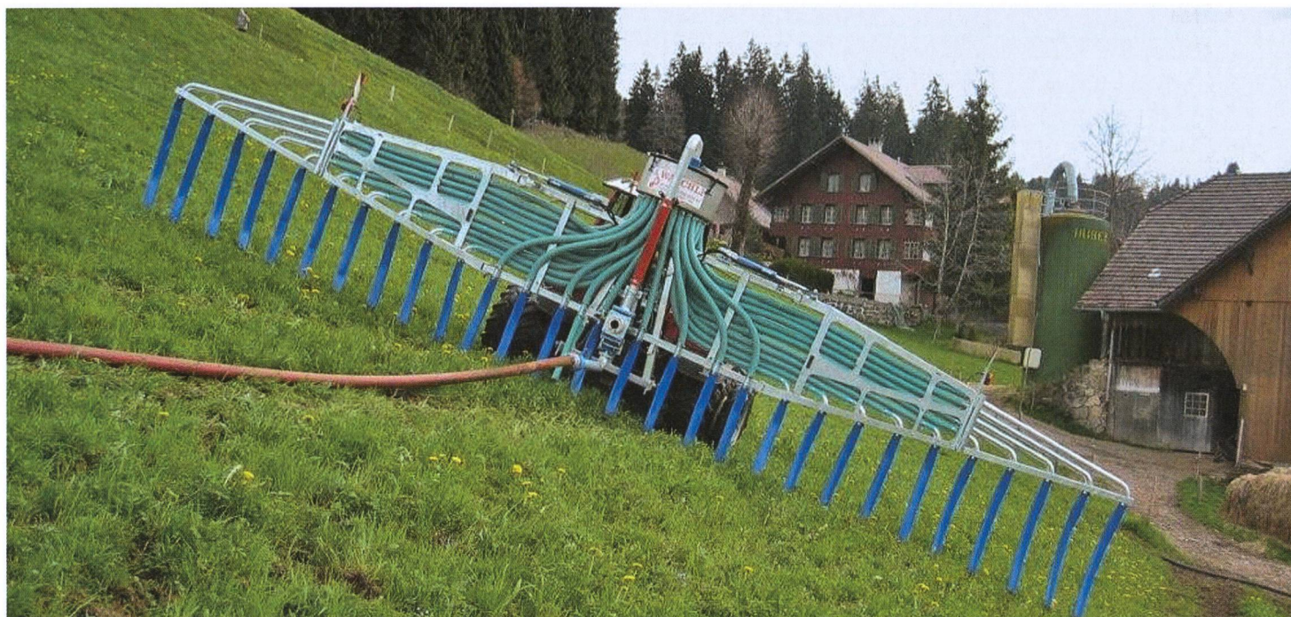
Epandeur à tuyaux souples Wälchli: Lorsqu'une pression de 0,5-1,0 bar est disponible dans la tête de répartition, il est aussi possible d'effectuer un épandage régulier sur les terrains en pente. (Photos d'usine)
