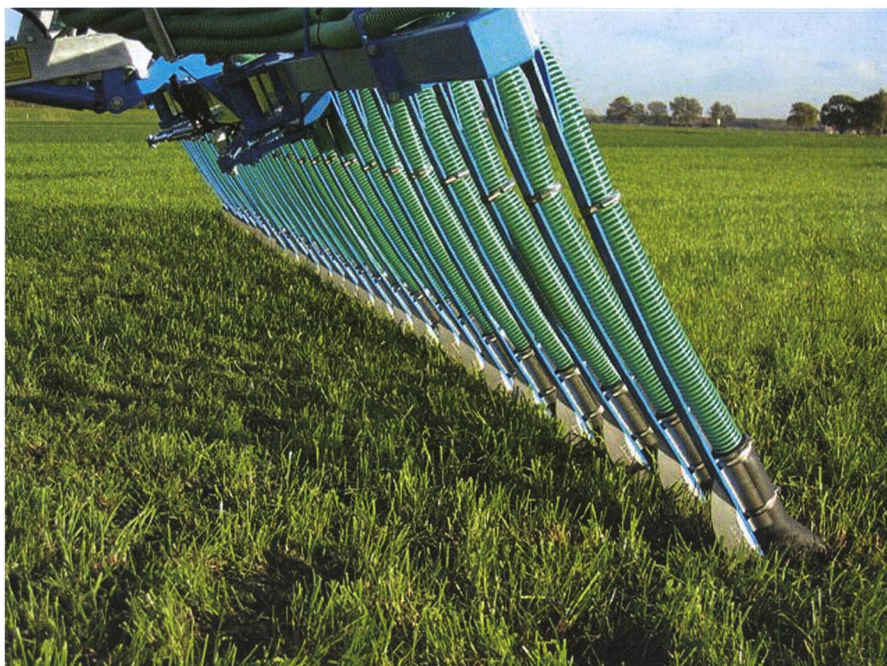
Patins Bomech: Les socs sont pressés sur le sol avec des ressorts en acier.
