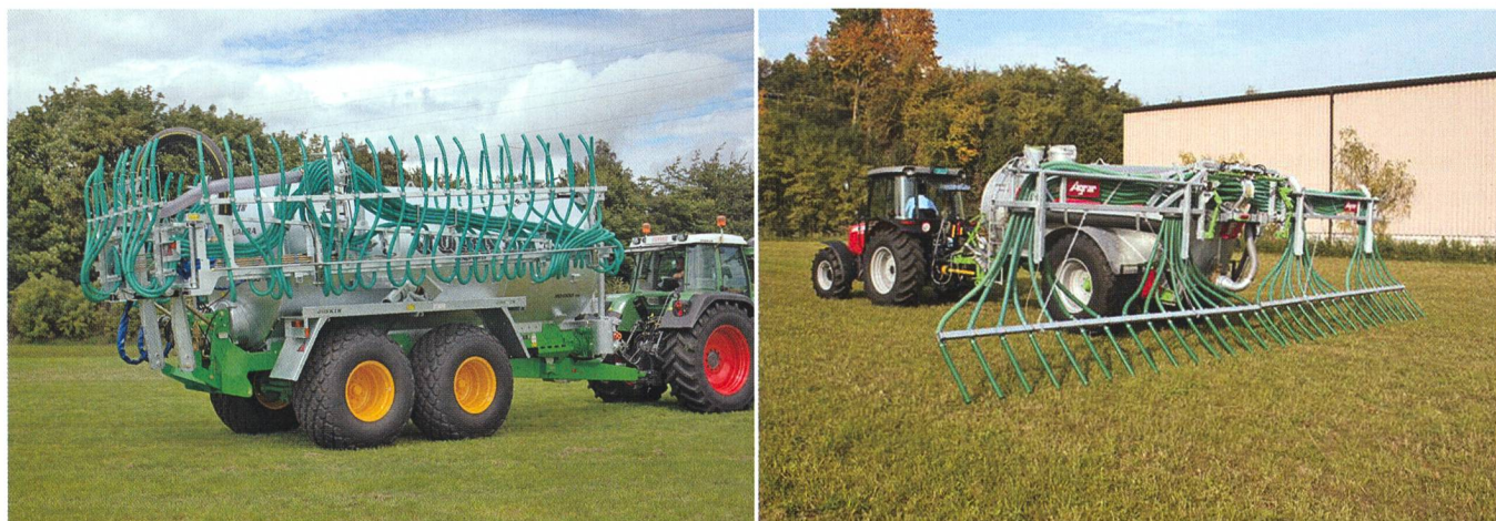
De nombreux cantons encouragent l'épandage du lisier avec des épandeurs à tuyaux souples: à gauche, citerne Agrar avec répartiteur Vogelsang, à gauche, citerne Joskin en position transport.
