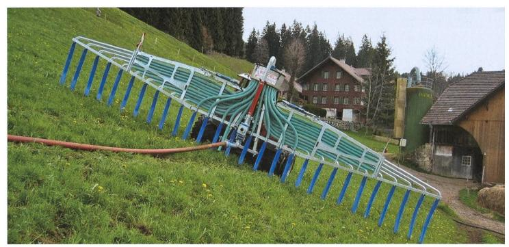
Epandeur à tuyaux souples Wälchli: Lorsqu'une pression de 0,5-1,0 bar est disponible dans la tête de répartition, il est aussi possible d'effectuer un épandage régulier sur les terrains en pente. (Photos d'usine)
