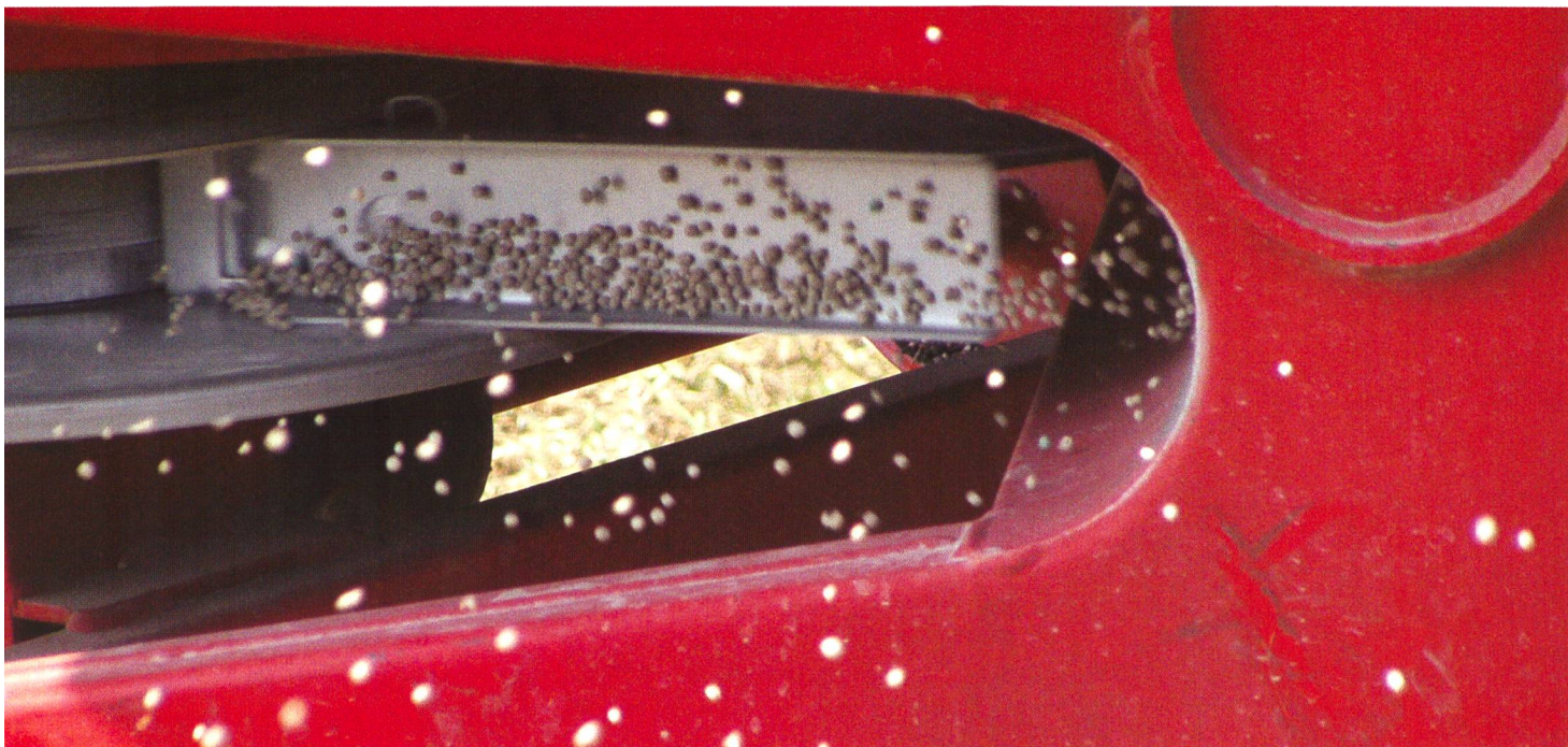
La volatilité des granulés d'engrais est déterminée par sa forme, sa densité et l'accélération. (Photos: Ruedi Hunger)
