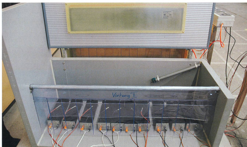
Fig. 3: Nid Isonest ATX ouvert (plaque chauffante 200 W). La sonde de température se trouve sur la paroi arrière.
