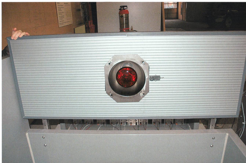
Fig. 2: Nid Isonest IR ouvert. A droite, à côté de la lampe infrarouge (150 W), on distingue le capteur IR.
