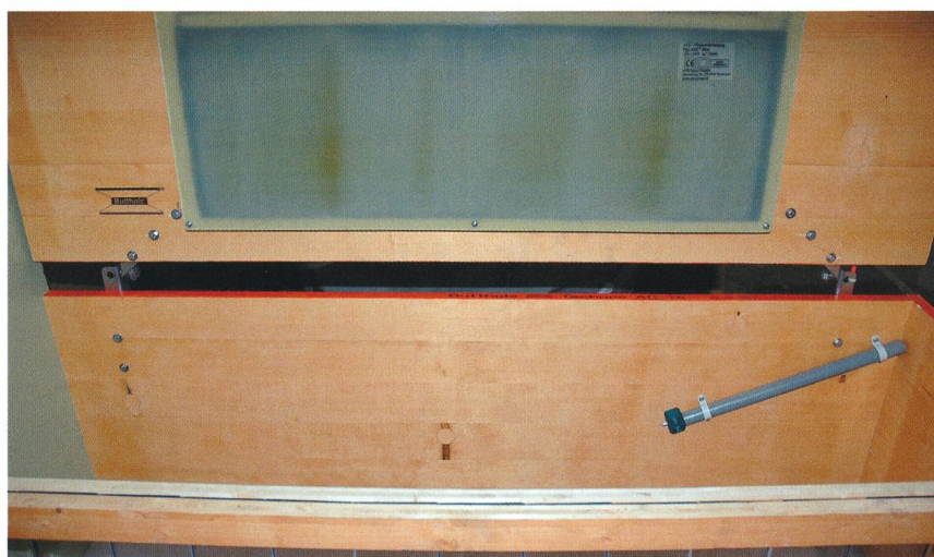
Fig. 4: Nid classique ouvert (plaque chauffante 290 W). Les parois sont faites de panneaux de coffrage.
