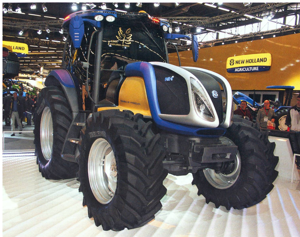
Futuriste, le New Holland T6000 dans son nouveau design et entraîné par énergie électrique. Celle-ci provient de piles à combustible alimentées à l'hydrogène.
