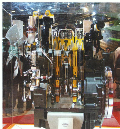
Nouvelle technique de moteur: tout se focalise sur le CommonRail, la réintroduction des gaz d'échappement, Ad Blue, etc. Il existe aussi des moteurs qui, grâce au réglage de l'injection mécanique-hydraulique et de hautes pressions, respectent les nouvelles normes en matière de gaz d'échappement. Par exemple le moteur 3 cylindres turbo avec refroidissement de l'air d'admission produit dans l'usine Same de Treviglio. Sa construction étroite permet son montage dans les tracteurs à voies étroites également (jusqu'à 120 CV).
