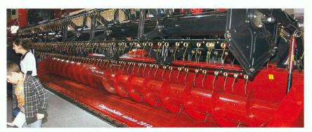
Case IH est spécialisé dans les moissonneuses-batteuses Axial Flow. Grâce à des rotors de plus grandes dimensions, la qualité de la paille doit s'améliorer. L'électronique et de nombreux facteurs mécaniques, entre autres l'agrandissement en continu du tablier de coupe, permettent l'amélioration des performances de récolte.
