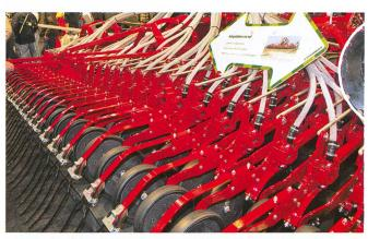
Semoirs Pöttinger Aerosem pour le dépôt précis de la semence et liaison articulée assurant une adaptation optimale au sol.
