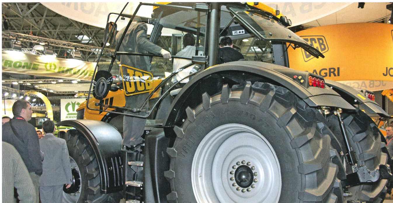
JCB Fastrac 7270 avec tous les attributs d'un tracteur classique. Force de levage arrière 9 tonnes, avant 3.5 tonnes. (Potos: Ueli Zweifel)
