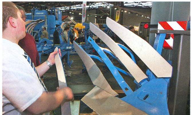
Lemken propose un système de changement des éléments d'une charrue à versoirs ajourés sans outils.
