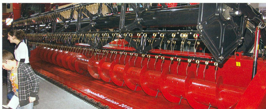
Case IH est spécialisé dans les moissonneuses-batteuses Axial Flow. Grâce à des rotors de plus grandes dimensions, la qualité de la paille doit s'améliorer. L'électronique et de nombreux facteurs mécaniques, entre autres l'agrandissement en continu du tablier de coupe, permettent l'amélioration des performances de récolte.
