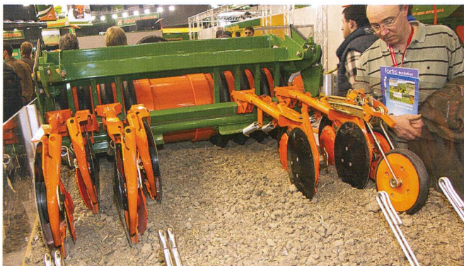
Amazone Roller Drill System: exemple de technique de semis de top-niveau pour une utilisation avec ou sans préparation du sous-sol. Rouleau à anneaux, socs à disque, rouleau compacteur et recouvreur veillent à des conditions de germination optimales.
