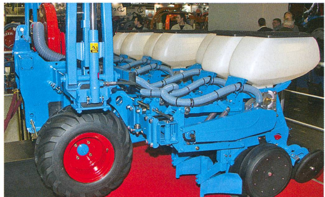
Semoir de précision Monosem avec sept éléments (relevables) pour le choix de la distance interligne.
