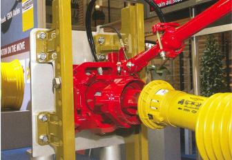
Système d'accouplement automatique PowerLock permettant un accouplement sur des arbres de transmission sans descendre du tracteur. Le système a été mis au point pas GKN-Walterscheid en collaboration avec Fendt et Pöttinger.
