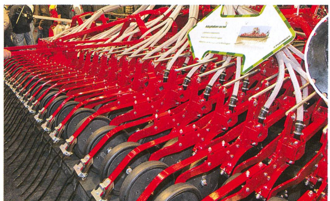
Semoirs Pöttinger Aerosem pour le dépôt précis de la semence et liaison articulée assurant une adaptation optimale au sol.
