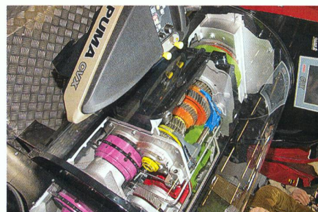
Le cœur du PUMA CVX, une transmission en continu à quatre gammes de vitesses et technique à double embrayage. Le moteur développe de 167 à 224 CV, avec un accélérateur (boost) à 250 CV.
