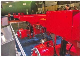
GKN-Automotive a exposé un châssis provenant de l'usine Telford (GB). Il dispose d'une fixation des essieux à assistance hydraulique et de particularités techniques qui permettent diverses économies en matière d'épaisseur des cloisons. Cela ne diminue pas seulement le poids, mais permet aussi une économie de matériel.
