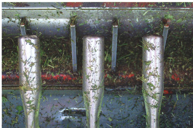
Les éléments de conditionnement mobiles nécessitent davantage de puissance que les éléments rigides.
