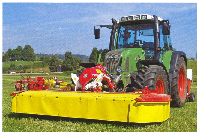
Faucheuse à l'avant et conditionneuse à l'arrière: idéal pour une bonne répartition du poids.
