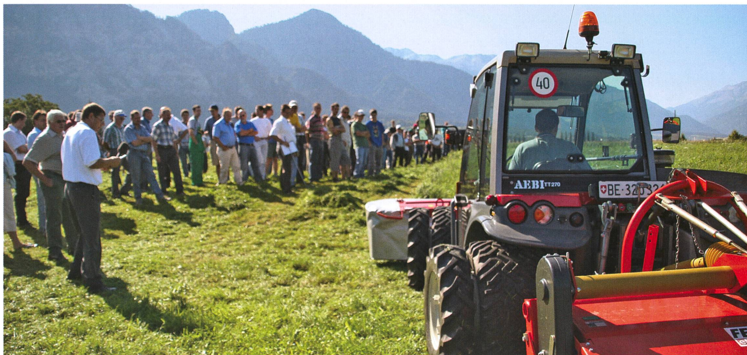
Une puissante faucheuse à deux essieux constitue une condition pour pouvoir bénéficier des avantages des conditionneuses dans les exploitations de montagne. (Photos: Patricia Wolf, Ruedi Hunger)
