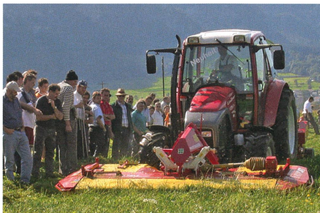
Les faucheuses frontales nécessitent un cadre trois-points avec cinématique sophistiquée.
