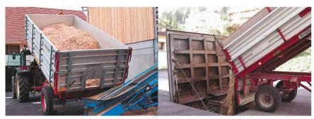
Fig. 14: Le déchargement des copeaux dans une fosse souterraine présente des avantages pour l'organisation du travail par rapport au tapis-roulant.
