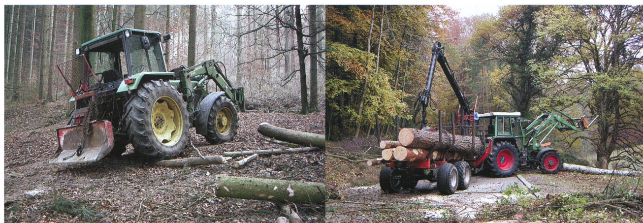
Fig. 4: Le treuil reste largement utilisé dans les forêts agricoles. Des remorques forestières équipées de grue sont parfois également utilisées.
