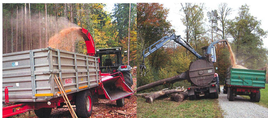
Fig. 12: Les broyeurs tractés ou portés entraînés à la prise de force conviennent bien pour les forêts agricoles. Les broyeurs automoteurs portés sont généralement utilisés en commun par plusieurs exploitations.
