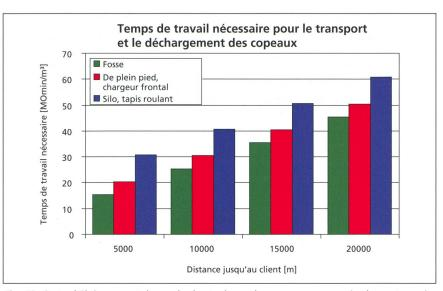
Fig. 13: Outre l'éloignement, le mode de stockage des copeaux exerce également une influence sur le temps de travail nécessaire lors de la livraison.
