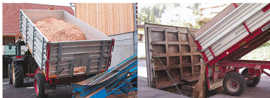
Fig. 14: Le déchargement des copeaux dans une fosse souterraine présente des avantages pour l'organisation du travail par rapport au tapis-roulant.
