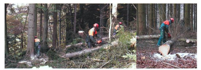
Fig. 2: Dans les forêts agricoles, l'abattage et l'ébranchage se font encore généralement à la main avec la tronçonneuse. Il est par conséquent impératif de porter un équipement de protection.
