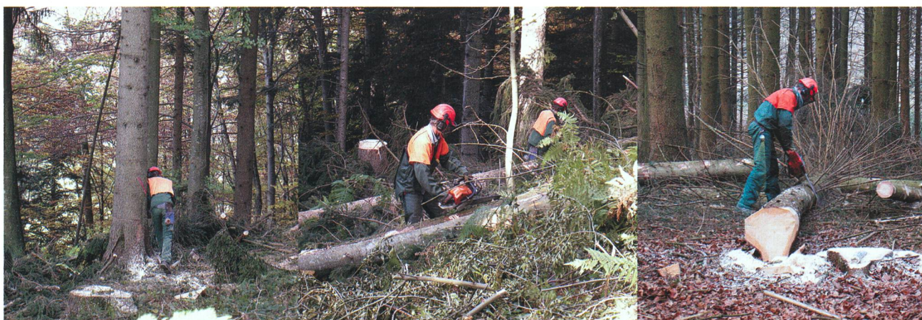
Fig. 2: Dans les forêts agricoles, l'abattage et l'ébranchage se font encore généralement à la main avec la tronçonneuse. Il est par conséquent impératif de porter un équipement de protection. (Photos: Isabelle Brecht, Agroscope ART)
