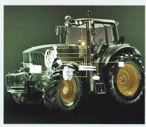
Sur le modèle E-Premium de John Deere, une génératrice reliée au vilebrequin produit de l'énergie avec laquelle un ventilateur à ailettes ou un compresseur peuvent être actionnés au besoin.
