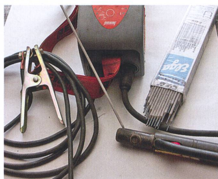
Le porte-électrodes et la pince sont surdimensionnés pour une utilisation grossière.
