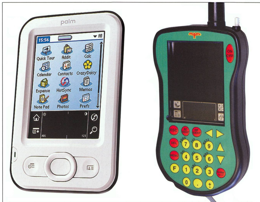
Fig. 5: A gauche PDA simple de Palm, à droite PDA robuste Milan MPX de Mannebeck avec lecteurs intégrés pour marques auriculaires électroniques et codes barres.
