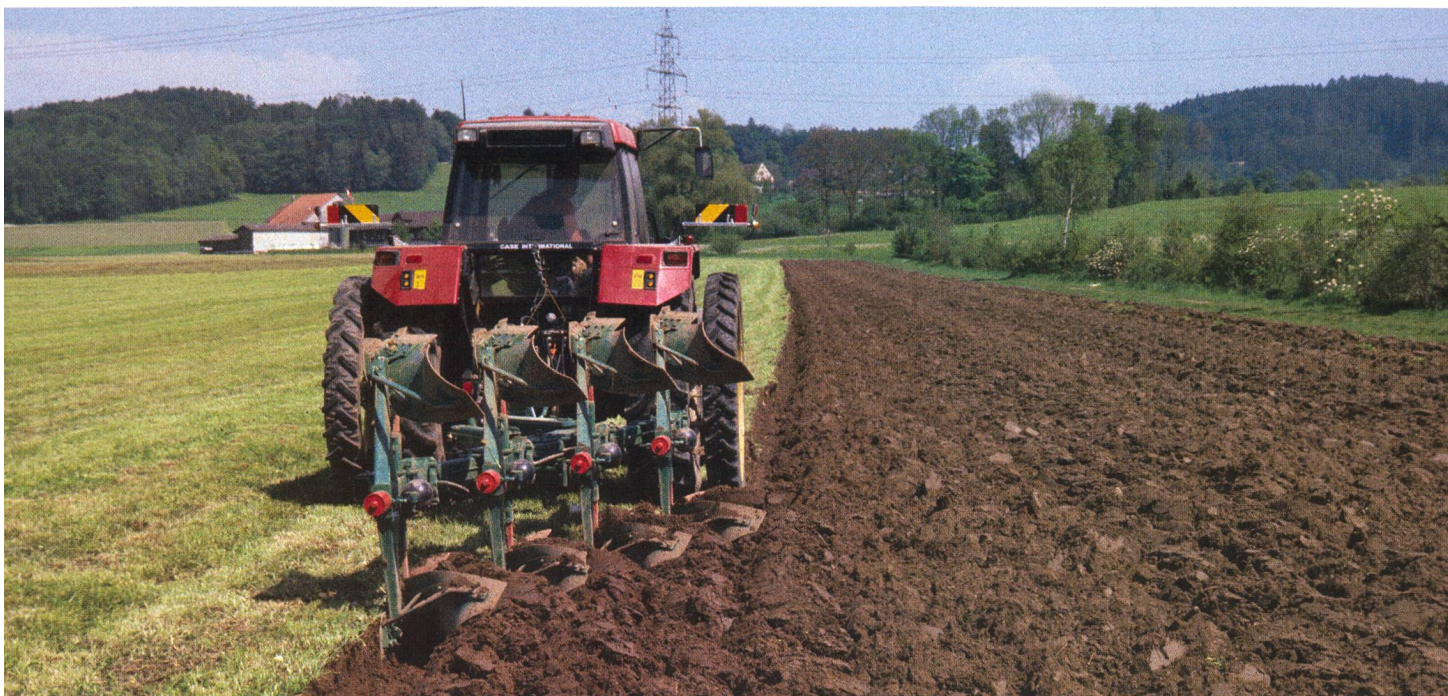
Des surfaces de travail plates et un réglage adéquat de la charrue permettent de réduire les besoins en carburant jusqu'à un tiers.
