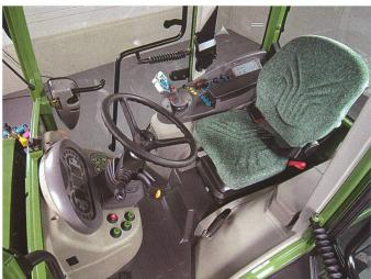
Petit Fendt maintenant aussi en continu: la construction compacte de la nouvelle transmission Vario permet de disposer d'un fond de cabine plat dans les tracteurs à voie étroite également. Fendt a été distingué pour cette conception avec une médaille d'argent du SIMA.
