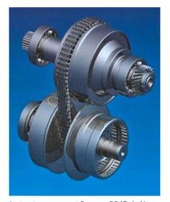
Le tracteur compact Boomer 3045 de New Holland est le premier en technique agricole équipé d'un variateur à chaîne. Le jury du SIMA a considéré que cela valait une médaille d'argent. Case New Holland mise, pour le Steyr CVT et Case IH Puma, sur une nouvelle transmission en continu de sa propre conception avec répartition de puissance. La transmission mécanique fait appel à un double embrayage.
