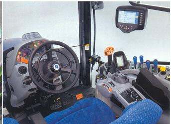
D'une butée à l'autre en un clin d'œil: le système FastSteer de New Holland le permet par simple pression sur la bague du volant avec un seul demi-tour.
