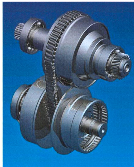
Le tracteur compact Boomer 3045 de New Holland est le premier en technique agricole équipé d'un variateur à chaîne. Le jury du SIMA a considéré que cela valait une médaille d'argent.
