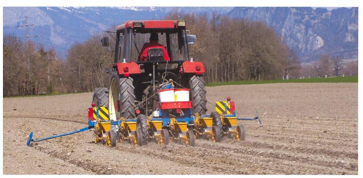
La semence de betteraves régulièrement enrobée peut être mise en place précisément avec un semoir mécanique simple. (Photos: Ruedi Hunger)
