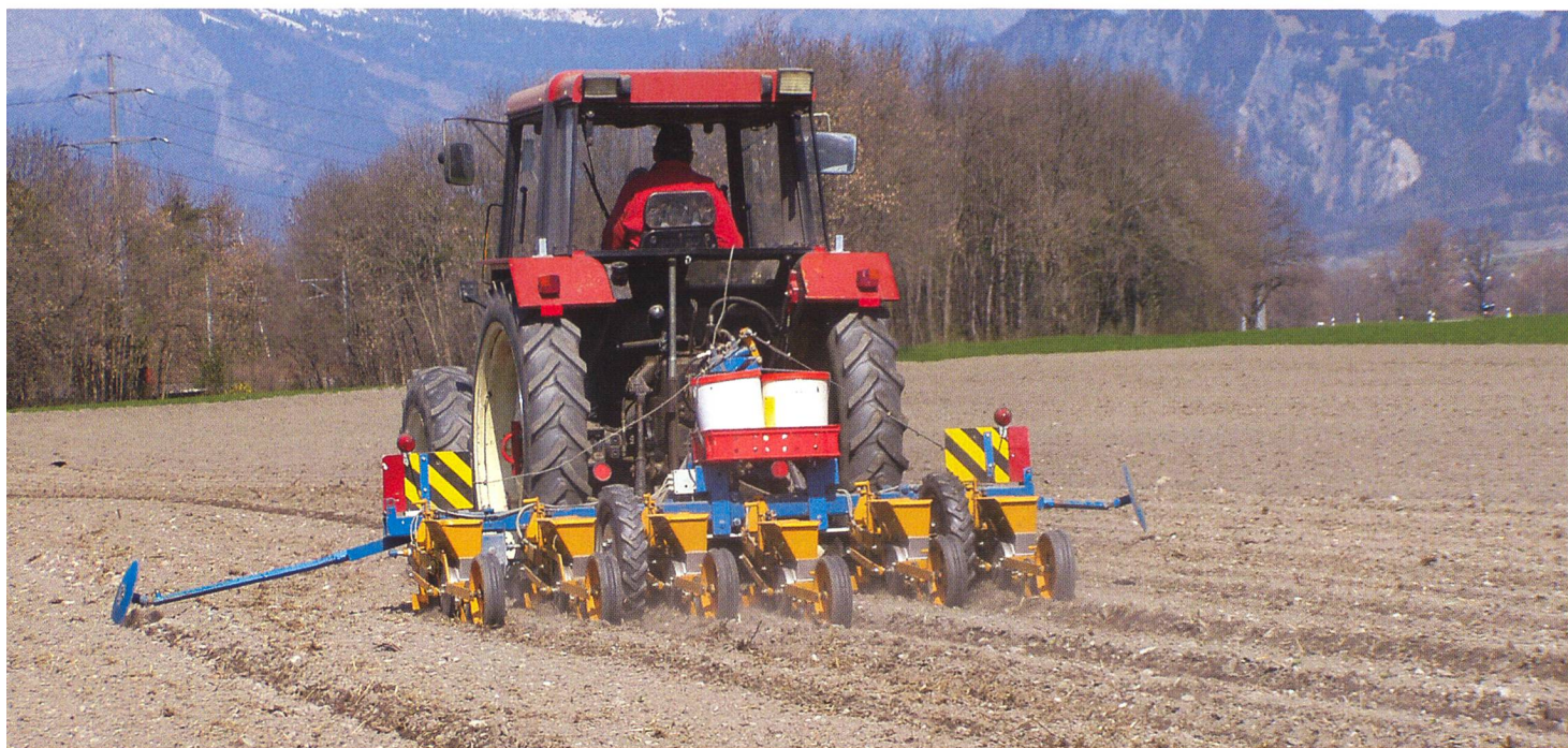
La semence de betteraves régulièrement enrobée peut être mise en place précisément avec un semoir mécanique simple. (Photos: Ruedi Hunger)
