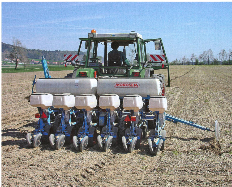
Semis direct dans un peuplement gelé de moutarde. Seules des machines spéciales lourdes conviennent au semis direct; il faut aussi veiller à ce que le sol soit suffisamment sec. (Photo: CBS).
