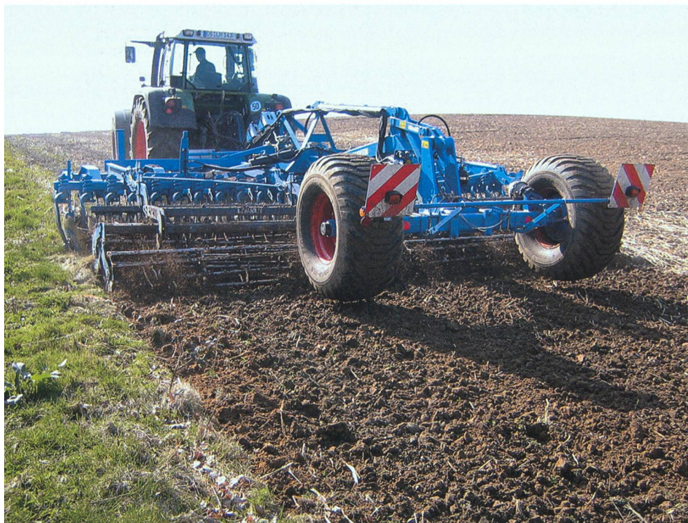
Enfouissement de la couche de litière: une herse combinée offre les avantages, par rapport à un outil animé à prise de force, d'une meilleure adaptation au sol, d'une intensité de travail réduite et de performances supérieures. (Photo d'usine Lemken).
