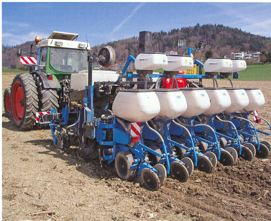
Lourdes machines de semis sous litière avec épandeur d'engrais intégré. Pour le recouvrement des graines, des disques recouvreurs, ainsi que des rouleaux compacteurs en V montés au centre ont fait leurs preuves. Les différents types de rouleaux compacteurs à bagues, métalliques ou à doigts et quirls travaillent sans bourrage. (Photo: Stefan Wyss).
