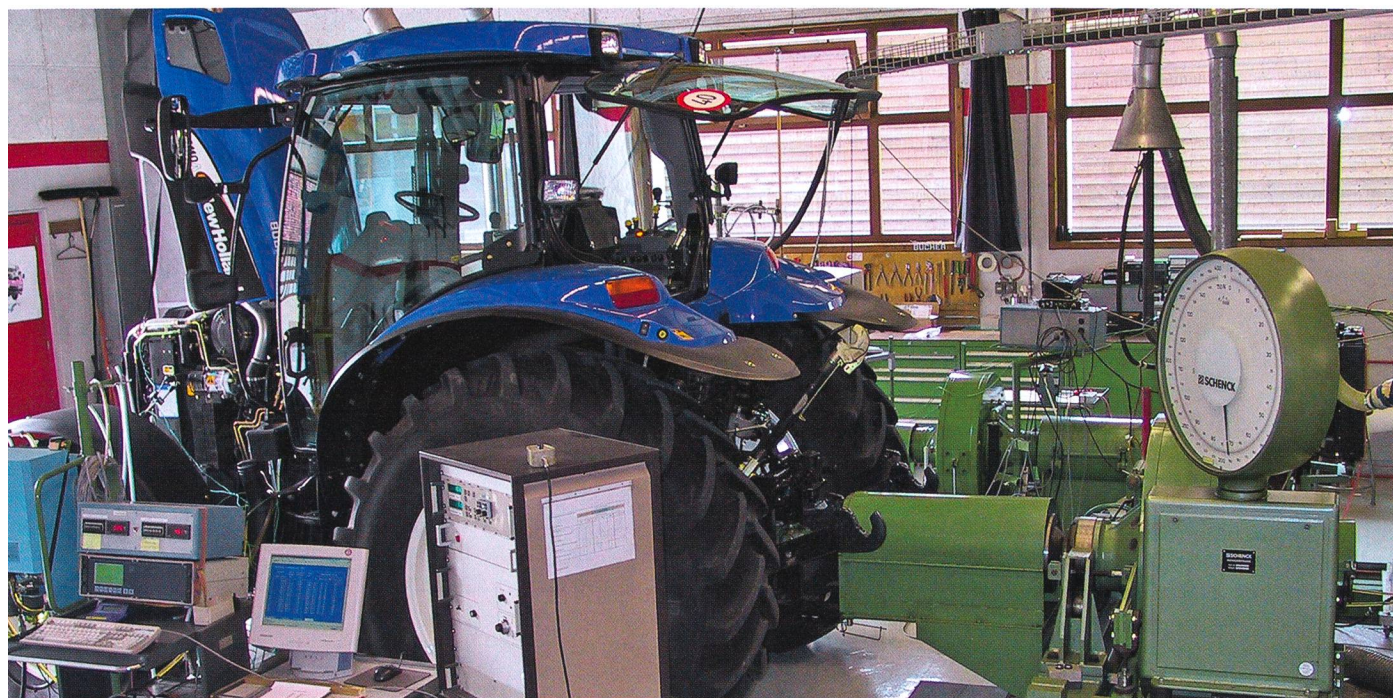
Les mesures de puissance et d'émissions de gaz d'échappement sur le banc d'essai de Tänikon fournissent des données objectives pour les tracteurs. (Photo: ART)
