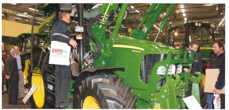
La nouvelle série de tracteurs 5R avec moteurs Common-Rail et refroidissement de l'air d'admission remplace la série 5020. (Photos: Ueli Zweifel)
