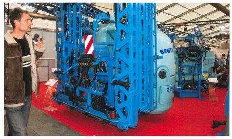
Nouveauté: les rampes rabattables ULYS de 18, 20, 21 et 24 mètres des pulvérisateurs Berthoud. Grâce au mécanisme de repli, les dimensions extérieures diminuent tant en largeur qu'en hauteur. Les rampes étant directement fixées sur le trois-points hydraulique, la stabilité s'avère meilleure et le centre de gravité de l'ensemble de la machine se rapproche du tracteur.
