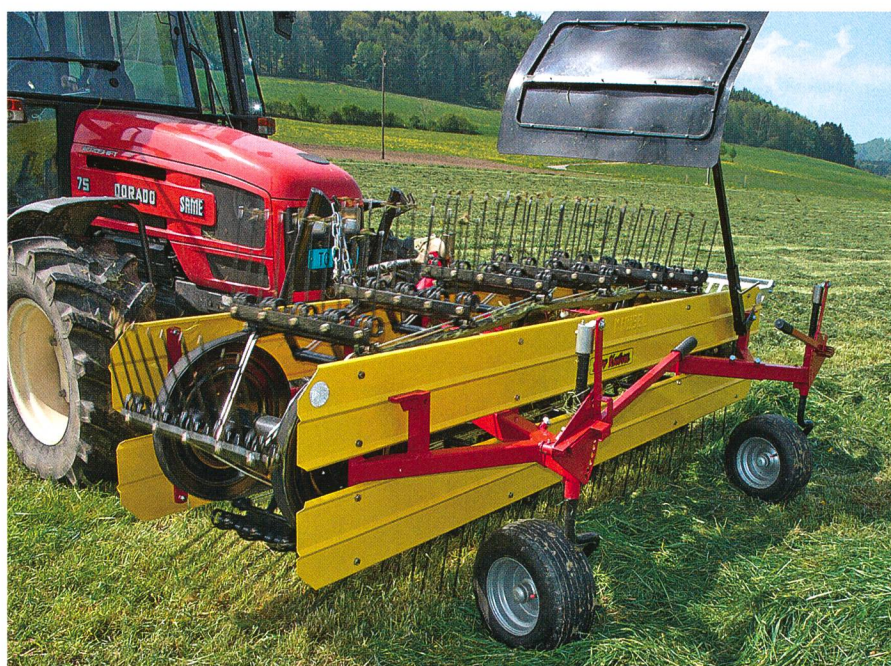
Le râteau-faneur présente un intérêt surtout en région de montagne et sur surfaces irrégulières.
