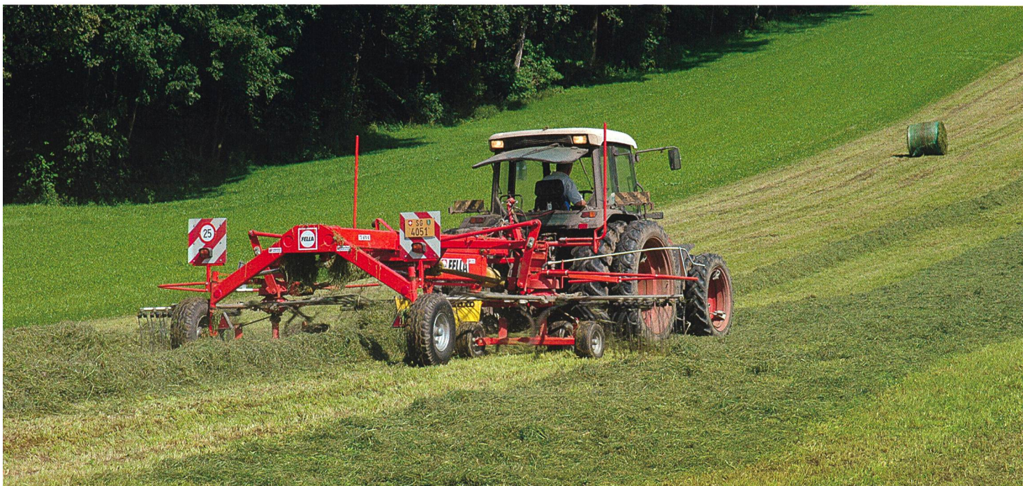
L'andaineur double toupie démontre ses avantages lors de la première coupe, lorsque les quantités de fourrage sont importantes, ainsi qu'en montagne en raison de sa meilleure stabilité directionnelle (Photos: Agroscope ART Tänikon). (Photos: ART)
