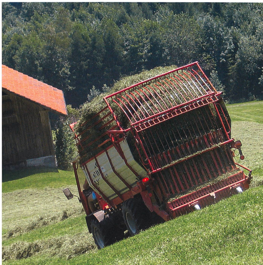
Lors de la récolte en région de montagne, les andains doivent être adaptés à la topographie. Cependant, des andains volumineux sont également intéressants afin de réduire le nombre de passages.
