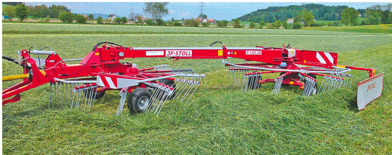
L'andaineur latéral s'avère idéal pour les petits tracteurs. Il reste très intéressant pour de petites quantités de fourrage.
