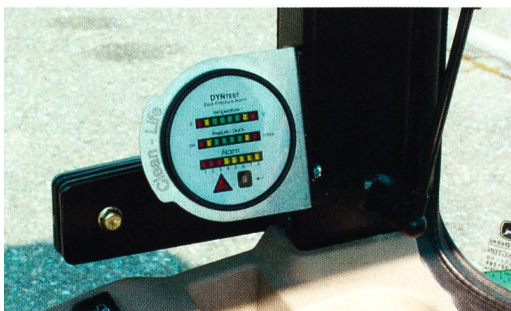
Les expériences réalisées contribuent au développement des systèmes. Matra a, par exemple, remplacé son indicateur de contre-pression.
