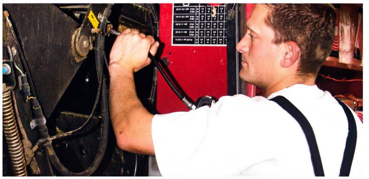
«La tournée de graissage» est nécessaire pour localiser assez tôt les parties endommagées. (Photos: Hansueli Schmid)
