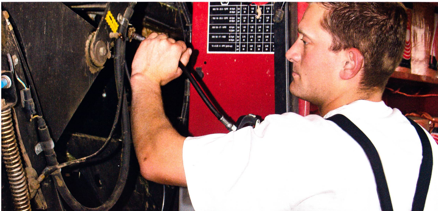
«La tournée de graissage» est nécessaire pour localiser assez tôt les parties endommagées. (Photos: Hansueli Schmid)
