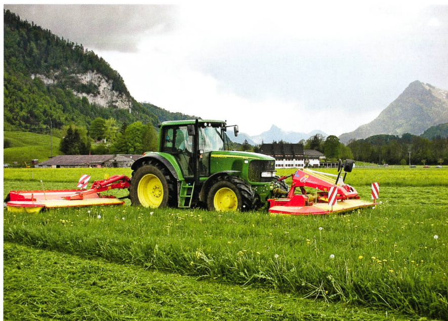
La faucheuse d'une largeur de travail de 6 m permet des performances à la surface élevées et s'adapte très bien aux irrégularités du sol.
