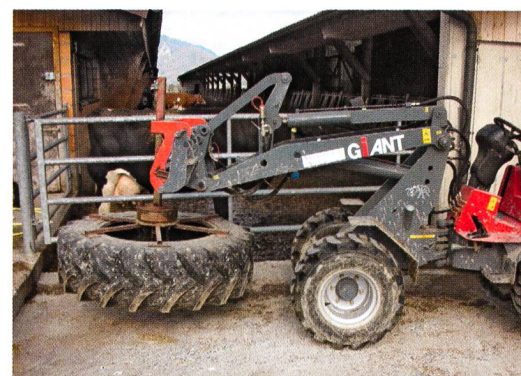
Un pousse-fourrage de fabrication «maison» permet de supprimer cette astreinte.
