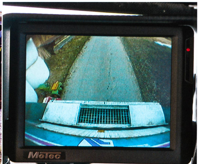
... soit elle se fait par le biais d'un système de caméra. La caméra est préférable, car elle offre davantage de sécurité dans les manœuvres.
