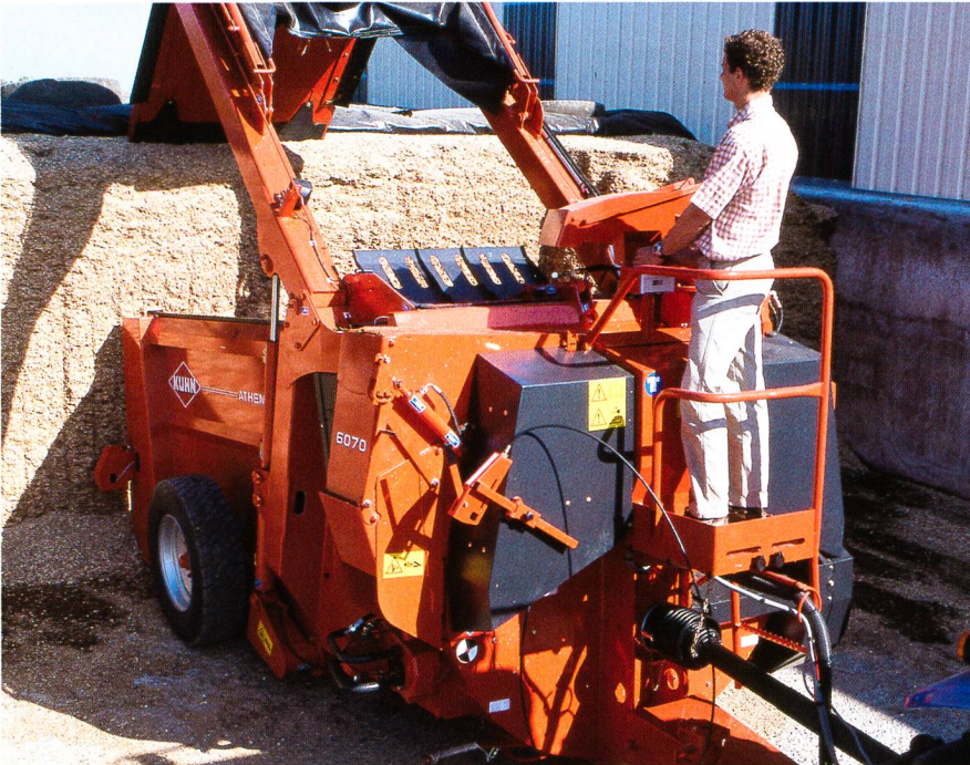
Commande à deux mains et principe de l'homme mort: Une main actionne l'écran de coupe, l'autre abaisse le bras. Dès que l'on lâche, la fonction s'arrête. Cette mesure technique impose le maintien des mains et des bras hors de la zone dangereuse. (Photo: Kuhn)
