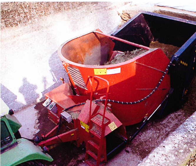
Soit la visibilité sur la zone de chargement est assurée de la place du conducteur par une paroi frontale perforée...
