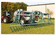
Pour le transport sur route, les bras se replient sur les côtés vers l'avant de la machine. Un verrouillage à la fois mécanique et hydraulique, combiné avec le système anti-gouttes, les maintiennent dans la position de transport.
