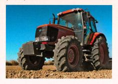
Les transmissions de la série M offrent selon les modèles de 15 à 48 vitesses avant et arrière, un inverseur hydraulique sous charge et des vitesses lentes. Les chargeurs frontaux pour cette série M sont également fabriqués par Kubota.
