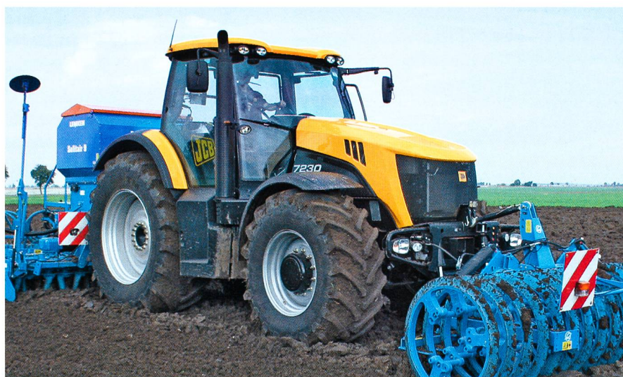
Tracteur standard ou Trac? Dotés de roues avant plus petites et d'une cabine en retrait, les Fastracs 7000 deviennent des tracteurs standard. Leur structure à quatre montants et leur suspension sur les deux essieux restent cependant «typiquement Trac».
