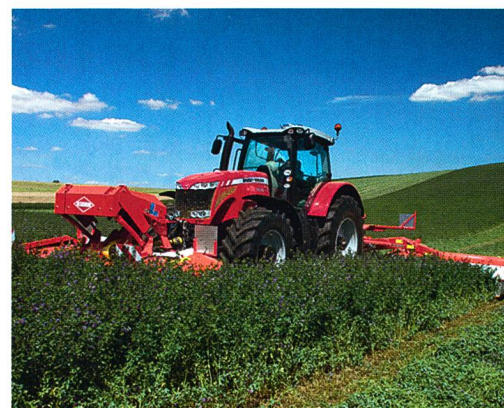
La série 8600 de MF se distingue par un système d'attelage avant intégré ILS d'une capacité de cinq tonnes.
