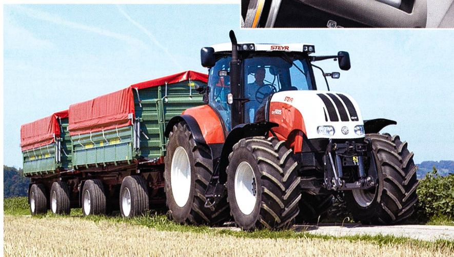
La nouvelle série CVT de Steyr est proposée avec une transmission en continu en provenance du groupe CNH. Le regroupement des commandes dans l'accoudoir droit est également nouveau.
