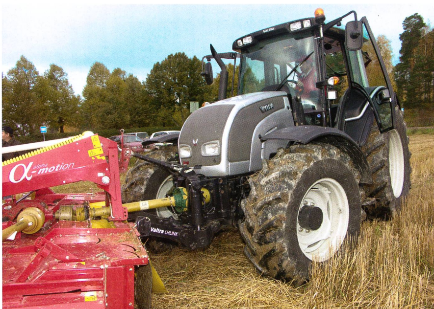
Le relevage frontal LHLINK de Valtra, s'orientant à l'intérieur dans les courbes, est également utilisé pour la nouvelle série N.
