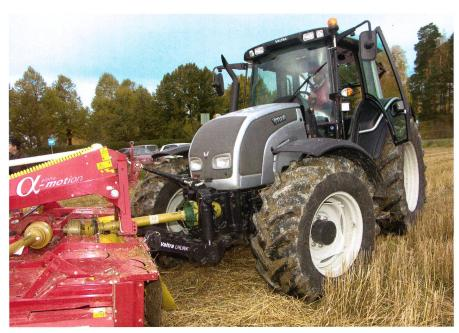
Le relevage frontal LHLINK de Valtra, s'orientant à l'intérieur dans les courbes, est également utilisé pour la nouvelle série N.
