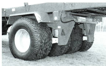
Train d'essieux Kurmann 4 roues Capacité de charge 10 tonnes avec suspension intégrée
