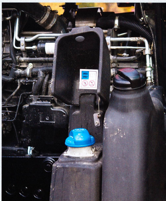
Les deux réservoirs côte-à-côte des S catalysés. A gauche la solution d'urée et à droite le diesel. (Photo: Alain Douard)
