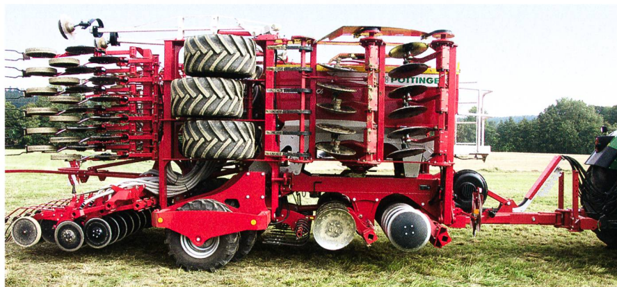
Terra-sem C6: Le châssis classique est remplacé par une unité combinée packer/châssis. L'outil qui précède peut être soit une herse à bêche roulante ou une herse à disques courte. La mise en place exacte de la semence est assurée par des doubles socs à disques montés sur parallélogrammes, suivies de roues plombeuses assurant le contrôle de profondeur.
