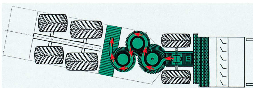
Fig. 1: Flux optimal de betteraves à l'exemple de la Ropa «Euro-Tiger» – de la reprise jusqu'au déchargement.
