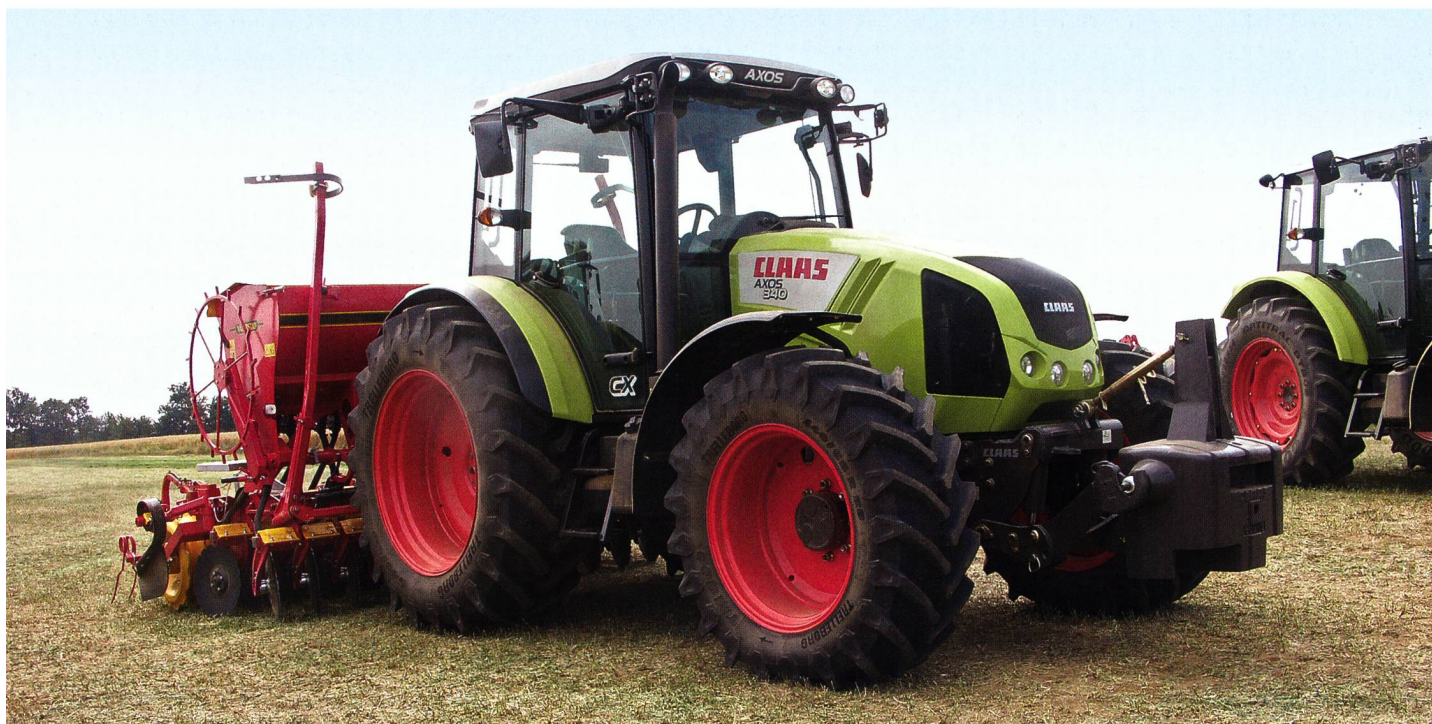
L'AXOS 340 CX équipé de la cabine standard, provenant de l'usine de cabines du Mans (F). Avec son essieu avant disposé très en avant, ce tracteur de 100 CV a une construction compacte qui permet une utilisation polyvalente.
