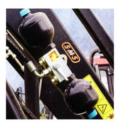
Les oscillations sont absorbées par des ampoules d'azote dans des systèmes passifs. Au besoin, l'amortissement peut être activé ou désactivé.
