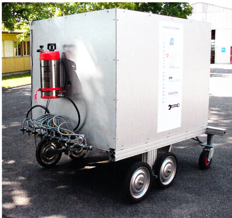
Fig. 1: Véhicule prototype avec un caisson contenant l'électronique de détection et une rampe de traitement de précision.
