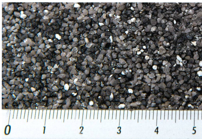
Fig. 2: Un traitement de surface optimisé avec du sable naturel permet d'éviter une usure excessive des sabots et d'assurer une bonne adhérence.
