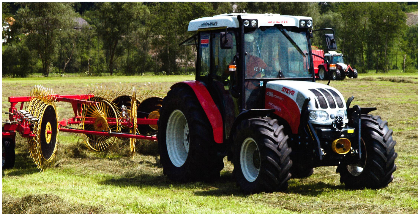
Sur le terrain plat, l'andaineur à roues-soleil avec dépôt central offre des performances à la surface élevées et ceci sans grands besoins en puissance. Les andains sont souples et aérés. (Photos: Poellinger)
