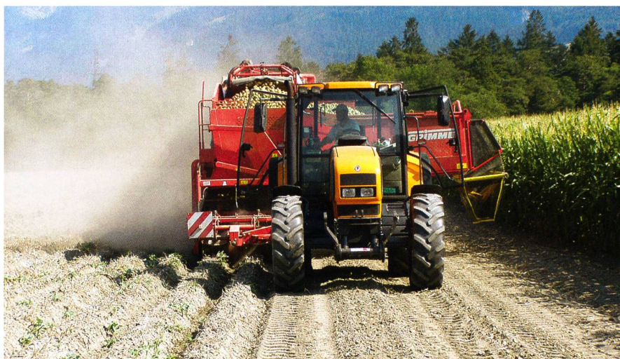
Une récolteuse totale de pommes de terre prélève environ 1000 tonnes de terre, de matériaux mélangés et de pommes de terre par hectare. Par conditions sèches, cela peut entraîner un fort développement de poussière. (Photo: R. Hunger)
