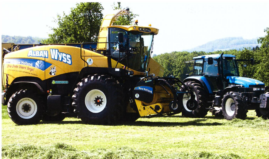
La FR 9060 en action pour la première fois. Sa cabine offre une vision circulaire optimale, par exemple sur le canal d'éjection qui peut être orienté sur 210°. Le niveau de bruit dans la cabine est très modeste avec 77 db(A).
