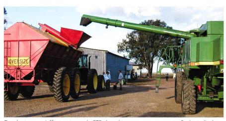
Tous les travaux s'effectuent, avec le CTF, dans des passages permanents. En Australie, les tuyaux de déchargement des moissonneuses-batteuses sont prolongés pour cela et les remorques de transport adaptées en conséquence.
