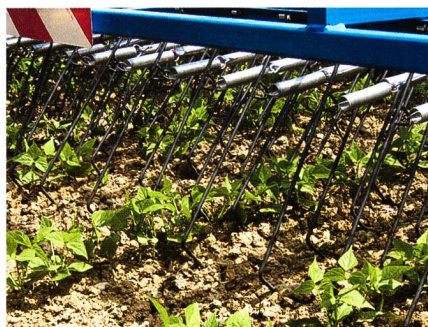
La herse étrille, la houe rotative et la herse à doigt peuvent être utilisés avec les oignons lorsqu'ils sont bien enracinés (photos: Martin Lichtenhahn, FiBL)
