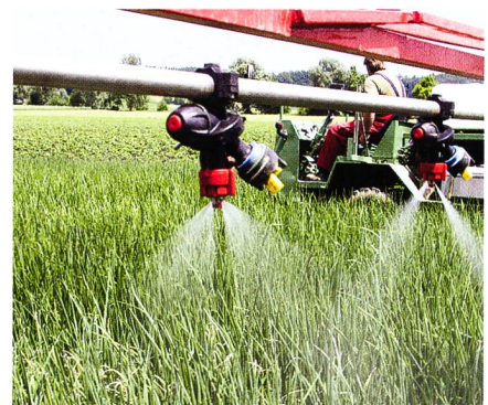
Traitement efficace avec des doubles buses d'injection
