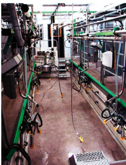
Fig. 12: Salle de traite Tandem 2x3, équipée entre autres de terminaux permettant de saisir la quantité de lait produite
