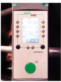
Fig. 12: Salle de traite Tandem 2x3, équipée entre autres de terminaux permettant de saisir la quantité de lait produite
