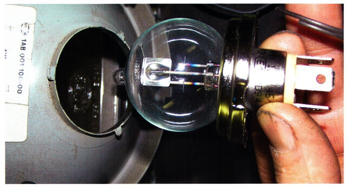
Les ampoules de phares doivent être placées exactement dans la bonne position.
