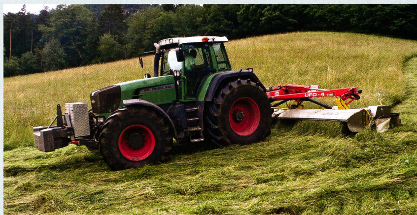
Montée à l'hydraulique arrière et pilotée en poste inversé, la faucheuse italienne R.O.C. UFO fournit d'excellentes performances de coupe
