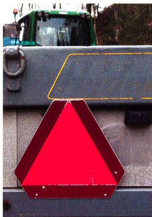
Le signal triangulaire rouge et réfléchissant est fixé à l'arrière des véhicules pouvant rouler à une vitesse maximale de 45 km/h.
