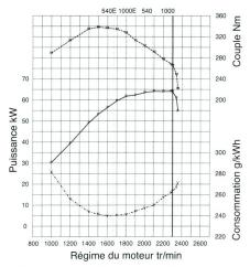
Fig. 3-5: Courbes spécifiques des moteurs de trois différents tracteurs (Source: Station de recherches Agroscope Reckenholz-Tänikon)
