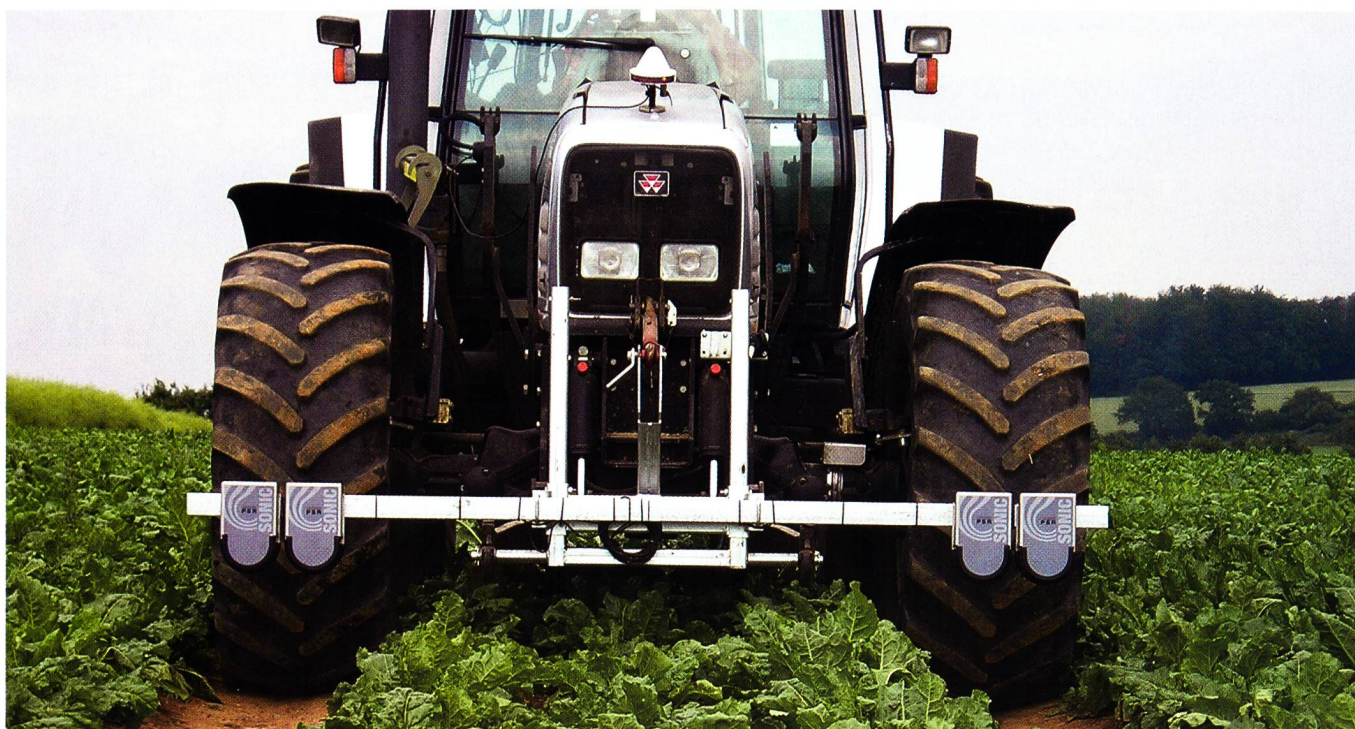
Guidage par ultrasons: le PSR-Sonic de Reichardt détecte – par ultrasons – les sillons, les voies de passage, les andains ou toute autre structure longitudinale (photo Reichardt, www.reichardt.org ).
