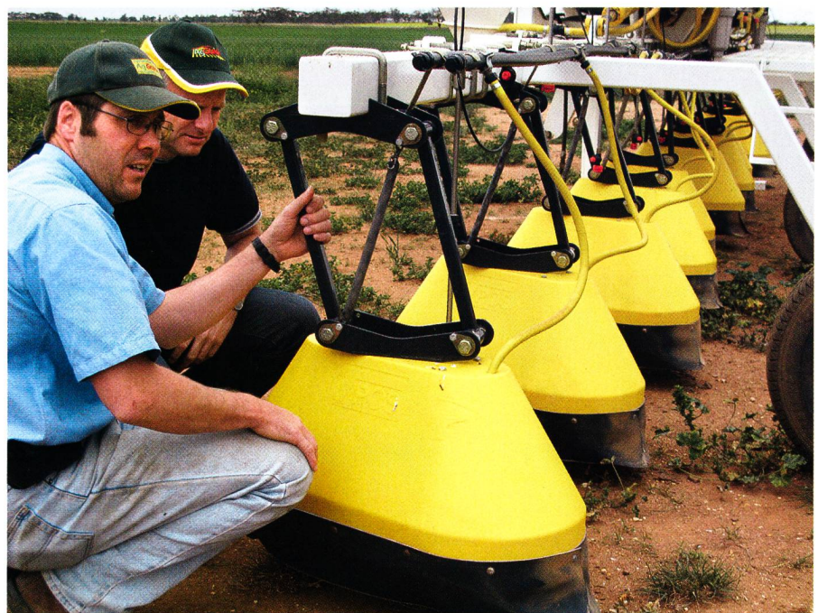
Application de glyphosate entre les lignes grâce au guidage GPS et cloches de protection en Australie. Des vitesses de travail jusqu'à 18 km/h sont possibles ( www.postlethwaite.com.au )
