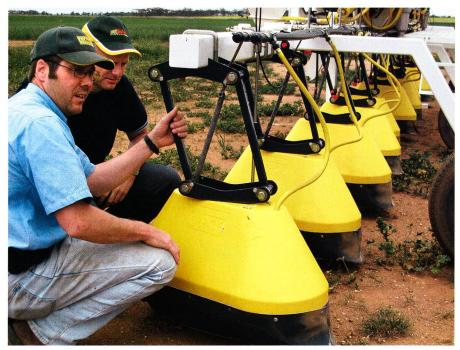
Application de glyphosate entre les lignes grâce au guidage GPS et cloches de protection en Australie. Des vitesses de travail jusqu'à 18 km/h sont possibles (www.postlethwaite.com.au)
