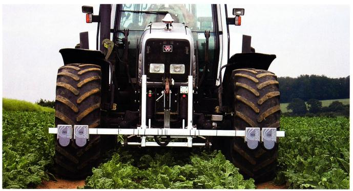
Guidage par ultrasons: le PSR-Sonic de Reichhardt détecte – par ultrasons – les sillons, les voies de passage, les andains ou toute autre structure longitudinale (photo Reichhardt, www.reichhardt.org).
