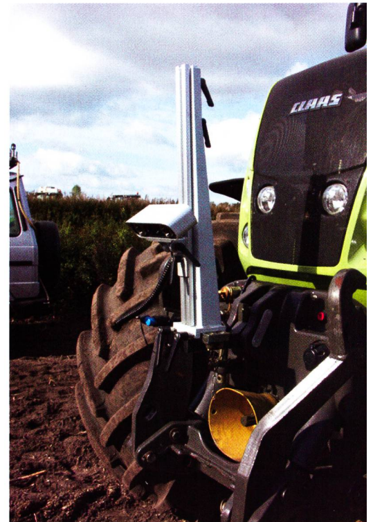
Contrairement aux systèmes de caméra simples, qui ne reconnaissent que les contours et les couleurs, le système de guidage EYE-DRIVE d'AGROCOM ( www.agrocom.com ) détecte également la troisième dimension au moyen de deux caméras.
